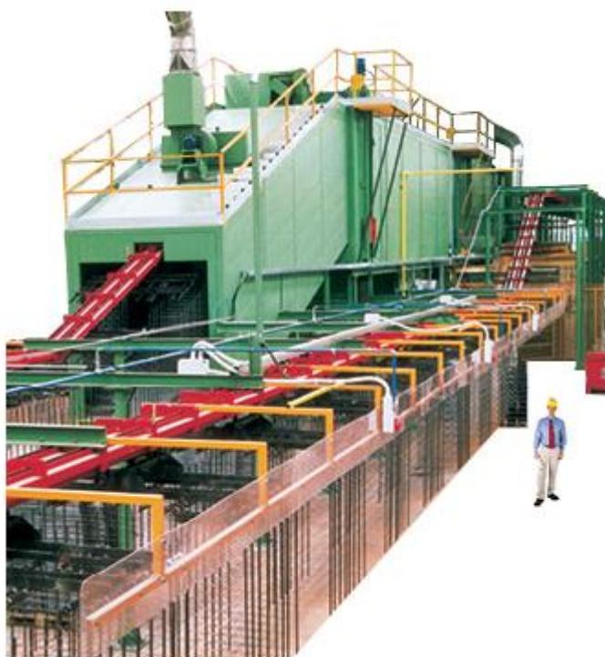
Figura 2: impianto per il trattamento Chrometherm.
